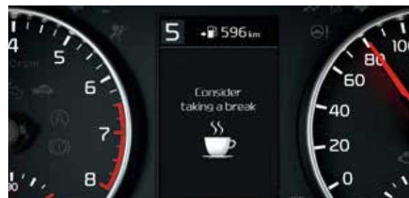
Müdigkeitwarner AA . Der Müdigkeitwarner (Driver Attention Warning, DAW) analysiert ständig verschiedene Fahrzeugparameter wie die Betätigung von Lenkrad und Blinker. Erkennt das System bei dir Zeichen von Erschöpfung, weist es dich durch einen Warnton und eine Anzeige in der Instrumenteneinheit darauf hin.
