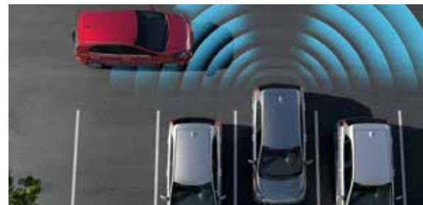
Querverkehrwarner AA . Beim Zurücksetzen aus Parklücken oder Einfahrten warnt dich der Querverkehrwarner (Rear Cross-Traffic Collision Warning, RCCW) durch optische und akustische Signale vor Fahrzeugen, die deinen Weg kreuzen. Bei den Ausführungen mit AMT-Getriebe erfolgt zudem automatisch ein Bremsengriff, wenn die Notbremsfunktion aktiviert ist.
